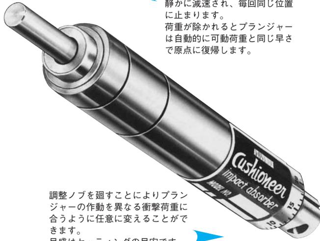
▶ プランジャーに当る可動荷重は静かに減速され、毎回同じ位置に止まります。荷重が除かれるとプランジャーは自動的に可動荷重と同じ早さで原点に復帰します。
